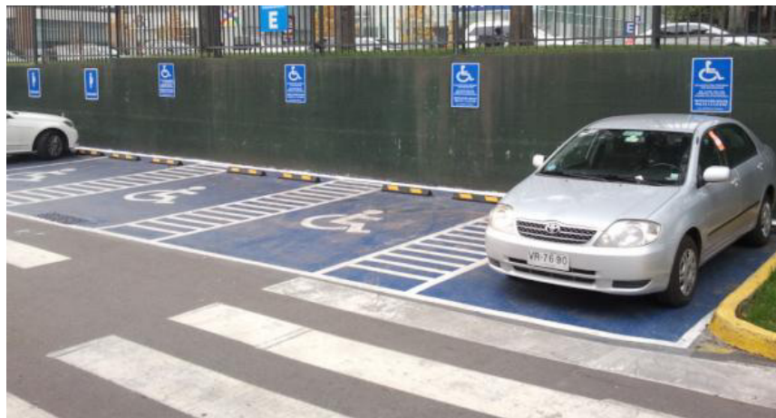
Estacionamientos privados de uso público con excelente demarcación, señalización y conexión a accesos (Lider Santiago)
