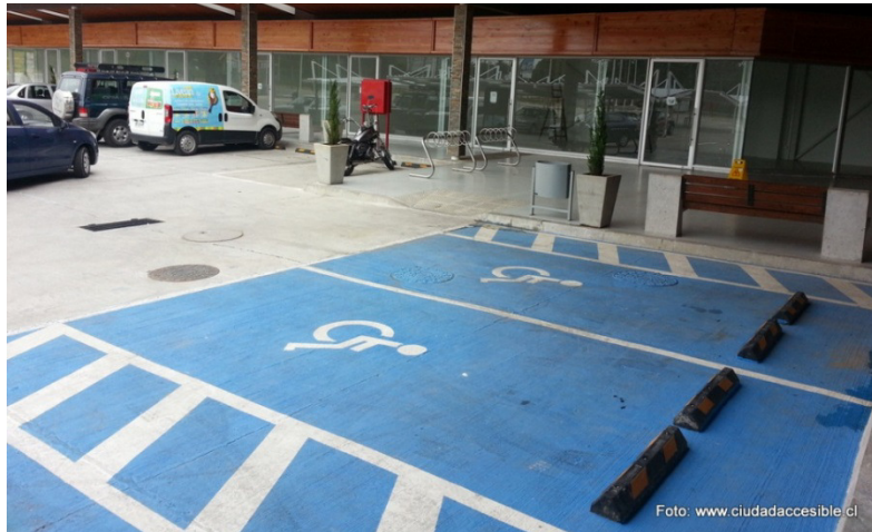
Estacionamientos para PcD, contiguos y comunicados al acceso. Distinguirlos en color favorece el correcto uso.
