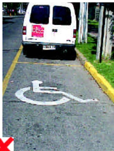
**Estacionamiento paralelo a la calzada de 2,50 m de ancho. Si el discapacitado es el chofer, queda expuesto a los demás vehículos que circulan por la calzada**
