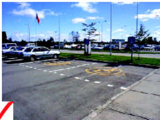
*Estacionamiento perpendicular de 2,50 m de ancho. No se puede realizar ninguna maniobra para subir o bajar del automóvil.*
