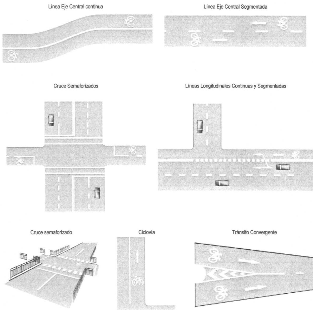
**Artículo 30°:** Los cruces semaforizados de una cicloruta permitirán regular la circulación de los ciclistas a través de las lámparas de semáforos vehiculares y peatonales. La señalización que advierte a los conductores de vehículos motorizados la proximidad de un cruce con una ciclovia no regulado, puede ser reforzada con luces intermitentes, según se describe en el Capítulo 6 del Apéndice.
