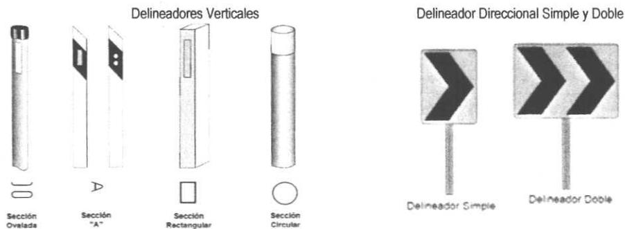
2. **Hitos de Advertencia:** Son elementos que se utilizan para reforzar el mensaje de advertencia sobre la existencia de una singularidad en la vía, como islas peatonales, bifurcaciones u otras aristas. En función de sus características físicas, se clasifican en: hitos verticales, hitos de vértice, hitos luminosos y luces.
