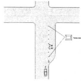
1.4. Otras Líneas Longitudinales: Indican a los conductores la prohibición de estacionar y las zonas de transición por reducción de pistas.
