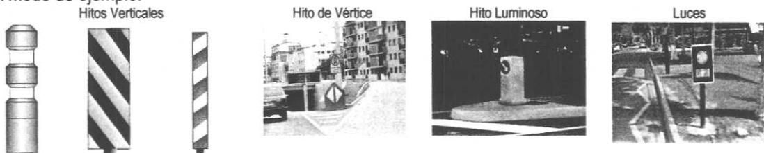
3. **Segregadores de Flujo:** Se utilizan para entregar a los conductores información que permita reforzar la separación existente en la vía, de áreas destinadas a distintos tipos de usuarios - vehículos y peatones - o a distintos modos de transporte - buses, vehículos livianos y bicicletas - , o bien, indicar la existencia de zonas con restricción de ingreso. En función de sus características físicas, se clasifican en: tachones, topes vehiculares verticales y topes vehiculares horizontales.
