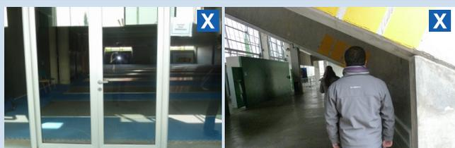
*Foto izq: Las puertas de vidrio requieren protección en su parte inferior para evitar golpes de los apoya pies de una silla de ruedas. Foto der: No deben existir circulaciones con obstáculos a menos de 2,1 m de altura para evitar accidentes a personas ciegas.*
