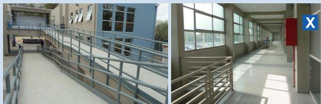
*Foto izq: Rampa de buena pendiente conduce a 2. piso en centro deportivo. Foto der: Los elementos volados que sobresalen en los pasillos pueden causar accidentes a personas ciegas que se usan la pared como guía de desplazamiento.*
