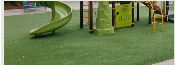
*El pasto sintético se utiliza sobre una superficie de caucho picado para dar la característica amortiguante.*
