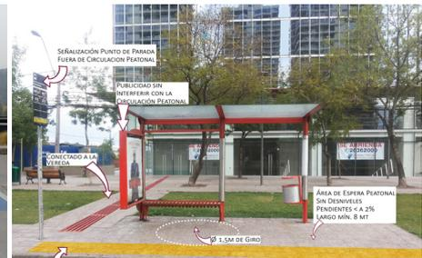
Foto izq: Estacionamiento PcD con conexión a vereda Foto der: Condiciones de accesibilidad de un Paradero
