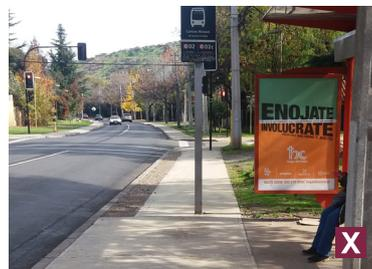
La señal de parada no debe anteceder el refugio, sino que marcar el punto de detención del bus. El emplazamiento del paradero no debe coincidir con la circulación peatonal de la vereda. En ambos casos se debió alinear el refugio a orilla de la calzada y desviar la vereda por la parte posterior del paradero manteniendo un ancho y circulación continuos.
