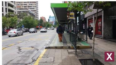
Si el andén se ubica sobre el nivel de la vereda y se utilizan los dos extremos para ingresar y salir, en ambos deben igualarse el modo de acceso mediante rampa. Los accesos deben estar libres de elementos, potenciales riesgos para personas ciegas además de obstruir los flujos de personas.
