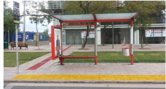
La imagen y foto superior muestran un paradero conectado a la vereda mediante una ruta accesible, sin desniveles ni obstáculos en la ruta o en el sector de espera, facilitando el flujo al abordaje o descenso del bus (Foto original modificada).
