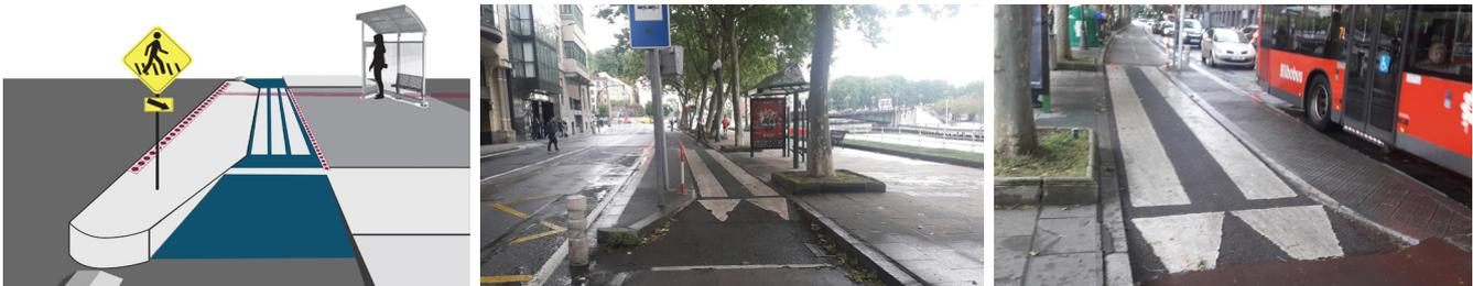
Figura izq. y fotos central y der: El angostamiento de la ciclovia permite ganar espacio a favor de un área segura de abordaje y descenso del bus. Se evita así compartir esta área donde no se tiene la visibilidad necesaria al descender en forma rápida, en especial para personas ciegas o con limitaciones físicas.
