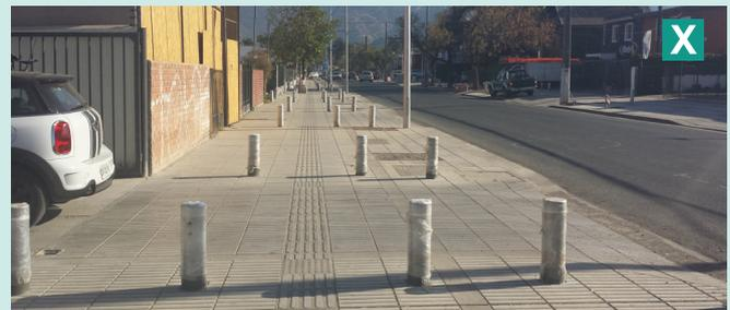
La instalación desmedida de bolardos en las veredas no facilita un flujo peatonal seguro y cómodo, en especial para personas ciegas. Todo elemento vertical debe ser instalado alineado y contiguo a la calzada
